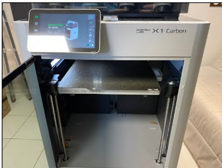
FIGURE 39 – L'imprimante doit être vide de toute impression et le plateau magnétique doit être en place.
