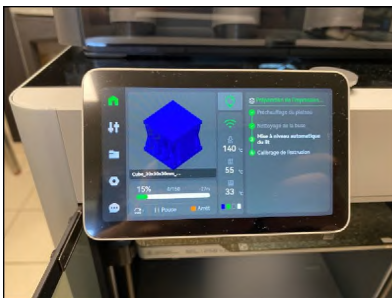
FIGURE 47 – Démarrage de l'impression : Mise à niveau automatique du lit
