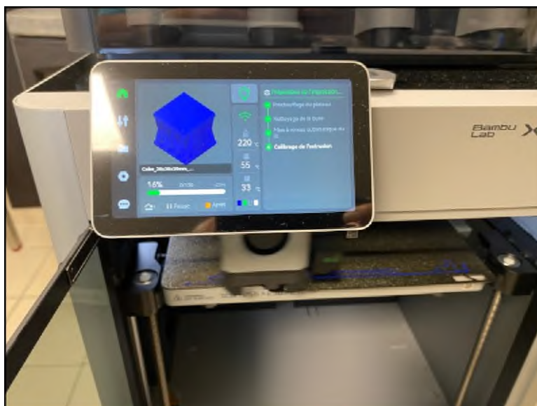
FIGURE 48 – Démarrage de l'impression : Calibrage de l'extrusion
