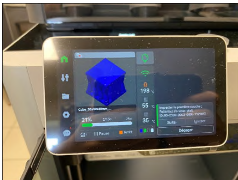
FIGURE 50 – Impression en cours : Inspection des premières couches
