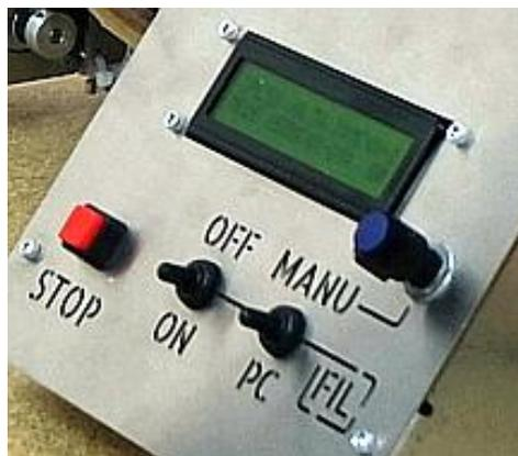
Enclencher le bouton **Tension des moteurs permanente** pour le temps du calibrage. Mettre la **chauffe au maximum** (bridé par les paramètres) et mettre le fil en chauffe en cliquant sur **ON** :
